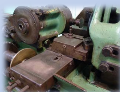
Вивчення кінематики і конструкції одношпиндельного токарно-револьверного автомату
