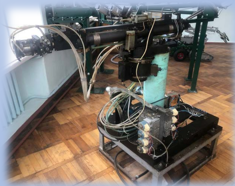
Ознайомлення з конструкцією та наладка промислового робота мод. БРИГ-10-3А3
