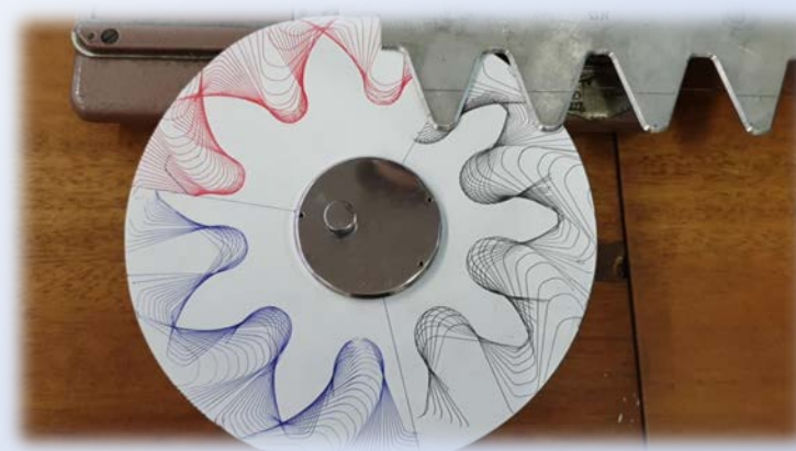
Побудова евольвентних профілів зубців за методом обкочування
