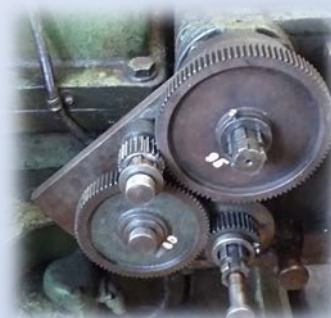
Настроювання зубофрезерного верстата на обробку циліндричних коліс
