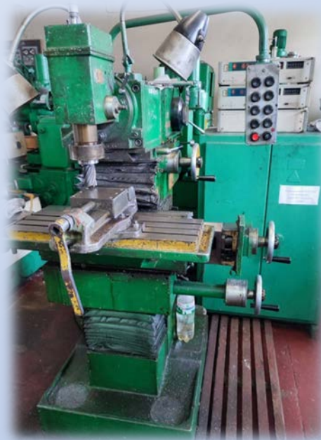
Фрезерування пазу під багатогранні непереточувані пластини твердого сплаву
