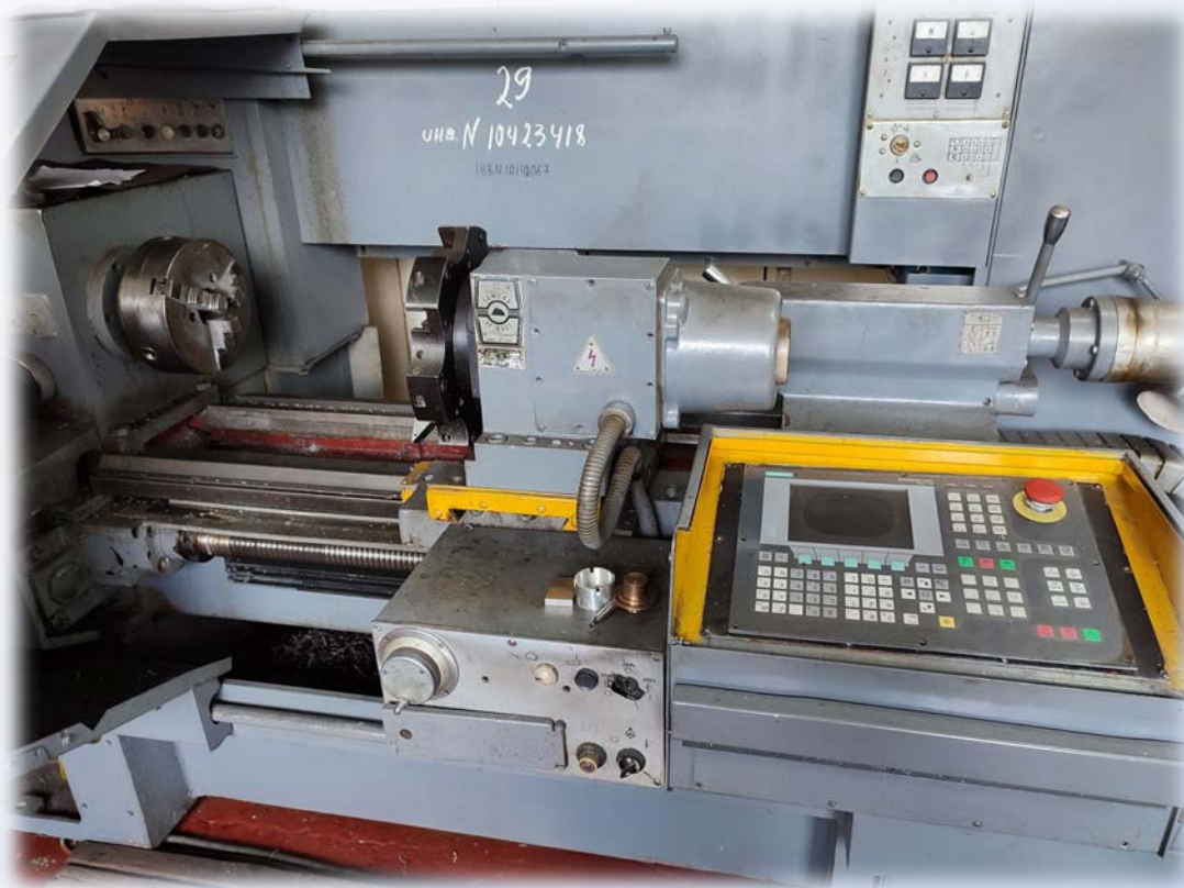
Модернізований токарний верстат з ЧПК, оснащений системою Sinumerik 802C
