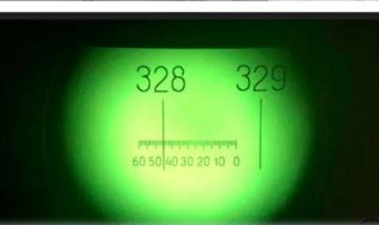
Вимірювання елементів метричної різьби на інструментальному мікроскопі
