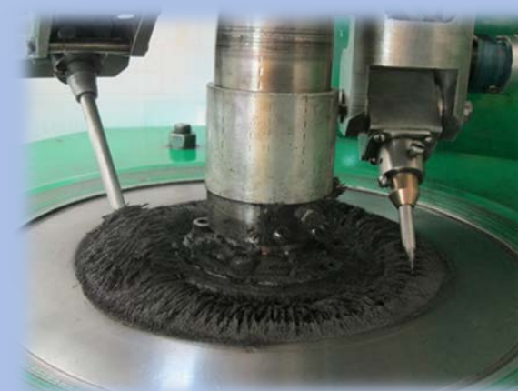
Магнітно-абразивне оброблення інструментальної сталі та твердого сплаву
