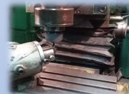
Фрезерування пазу під багатогранні непереточувані пластини твердого сплаву
