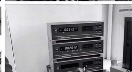
Вимірювання відхилень розташування осей отворів на координатно-вимірювальній машині
