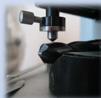
Вимірювання мікротвердості інструментальної сталі та твердого сплаву
