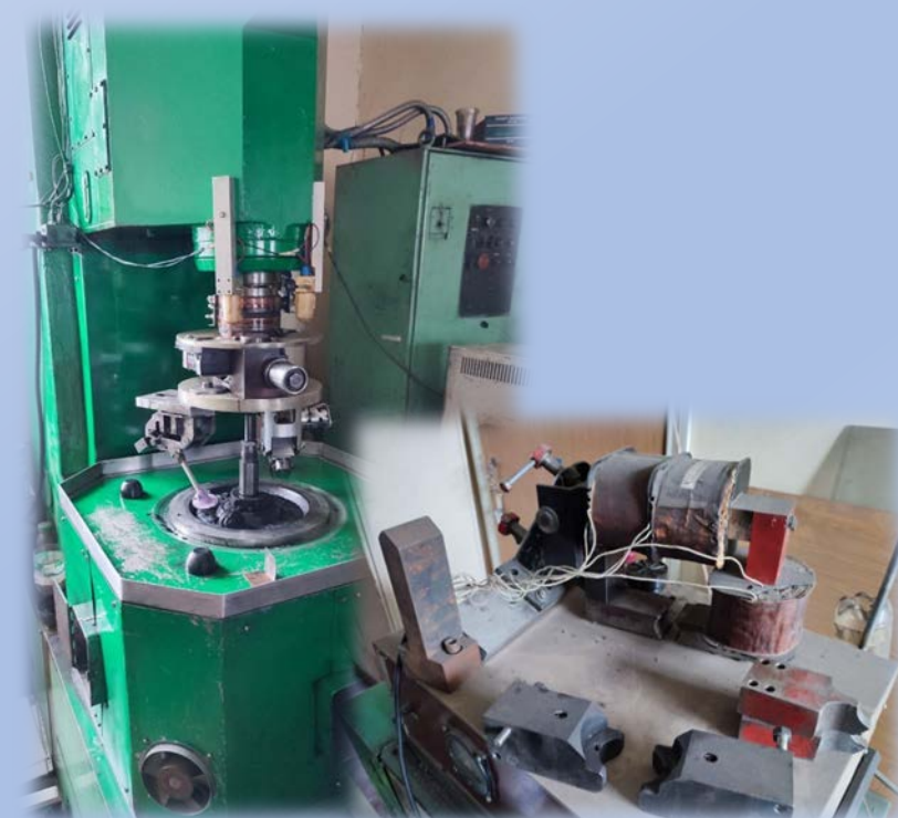
Обладнання для магнітно-абразивного оброблення деталей складної форми
