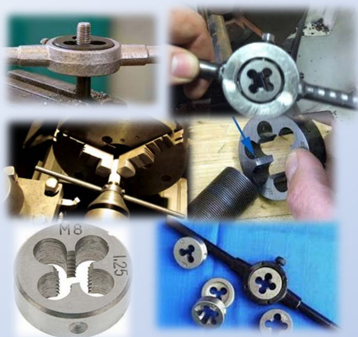
Інструмент для утворення зовнішньої різьби. Плашки. Конструкція, геометричні параметри
