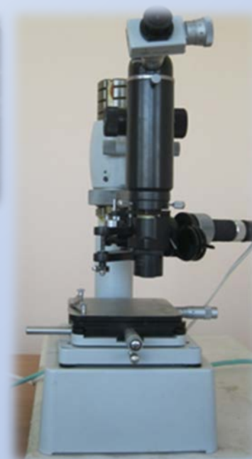
Вимірювання мікротвердості інструментальної сталі та твердого сплаву
