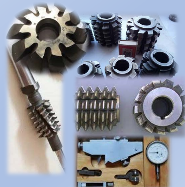
Інструмент для обробки зубчастих коліс. Фрези модульні
