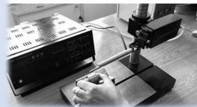
Оцінка шорсткості поверхні, визначення параметрів шорсткості за профілограмою
