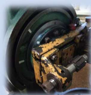
Настроювання зубофрезерного верстата на обробку циліндричних коліс
