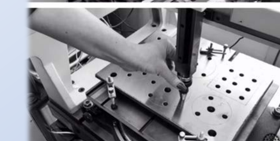
Вимірювання відхилень розташування осей отворів на координатно-вимірювальній машині
