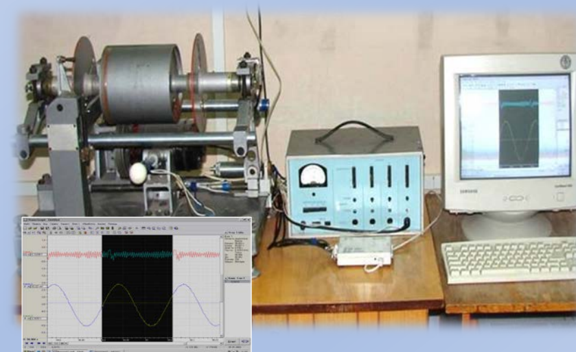
Динамічне зрівноважування ротора з невідомими розташуванням неврівноважених мас
