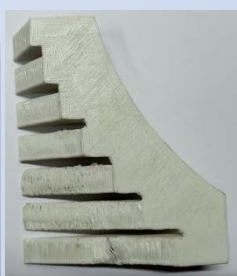
Дослідження впливу розташування деталей на робочій зоні принтеру на кількість та величину підтримок при FDM 3D друці
