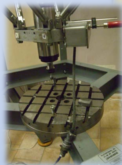
Дослідження просторового компонування мобільного робота на основі механізму гексаподу
