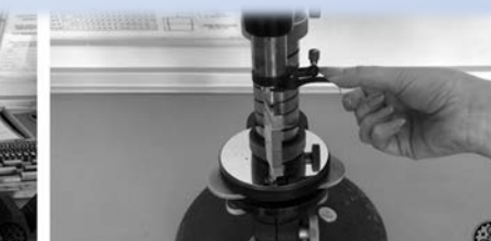
Лабораторна робота «Вимірювання відхилень форми циліндричних поверхонь»
