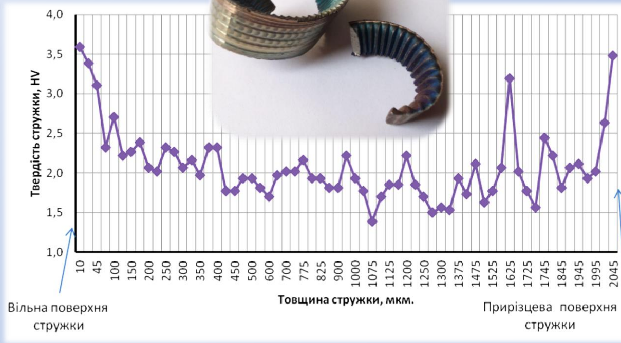
Визначення зміни структури та мікротвердості поверхневих шарів стружки
